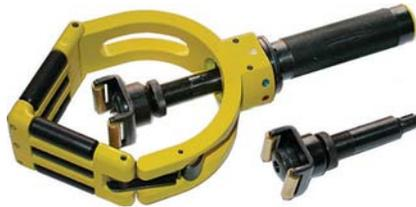
Per togliere guaine isolanti con forte spessore a cavi conduttori, di grandi dimensioni, mediante incisione circolare, longitudinale e diagonale. Corpo in acciaio ad alta resistenza e in lega di ALLUMINIO pressofuso. Lama in acciaio SUPER-RAPIDO. Provvisto di vite micrometrica per la regolazione di profondità
